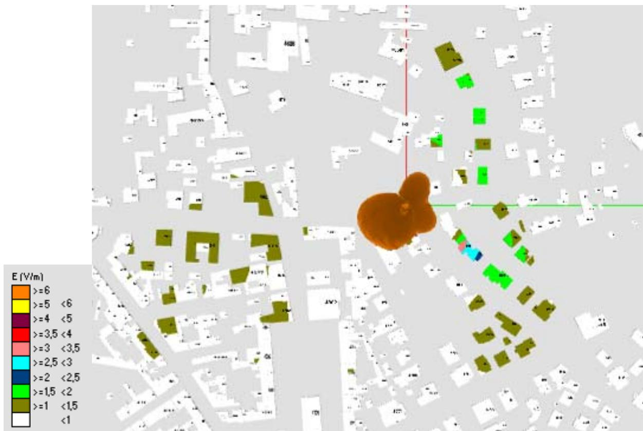
Figura 9.3.8 TIM PT06 Vista in pianta dei livelli di campo elettrico sugli edifici
