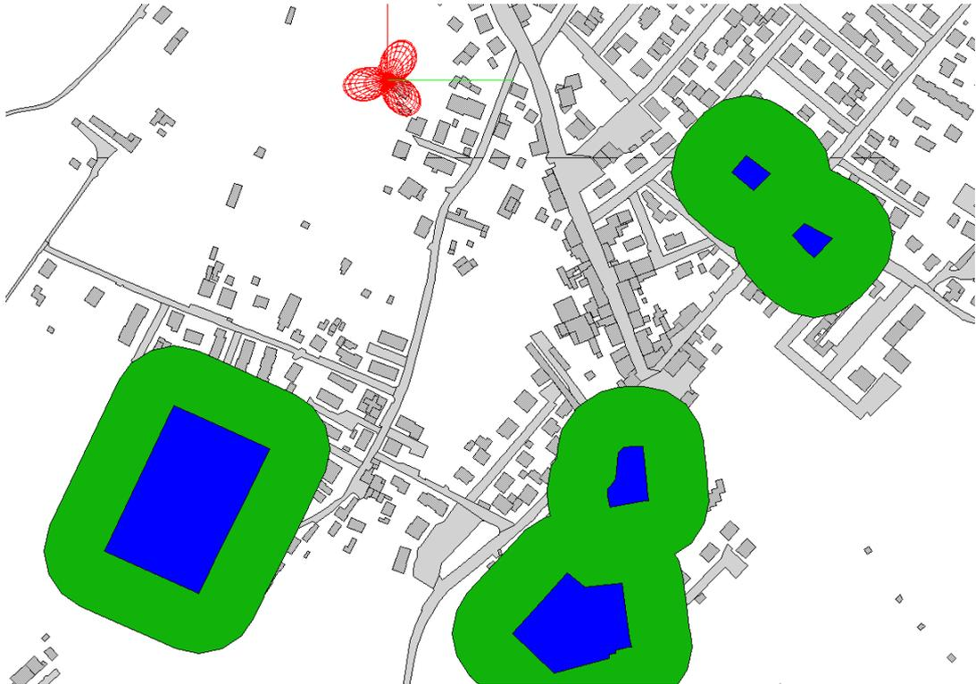
Figura 9.2.2.4 TIM PT4F Cintolese Via del Carro - Vista in pianta del solido di irradiazione a 6 V/m (edifici ricettori sensibili con area di pertinenza di 50 m)
