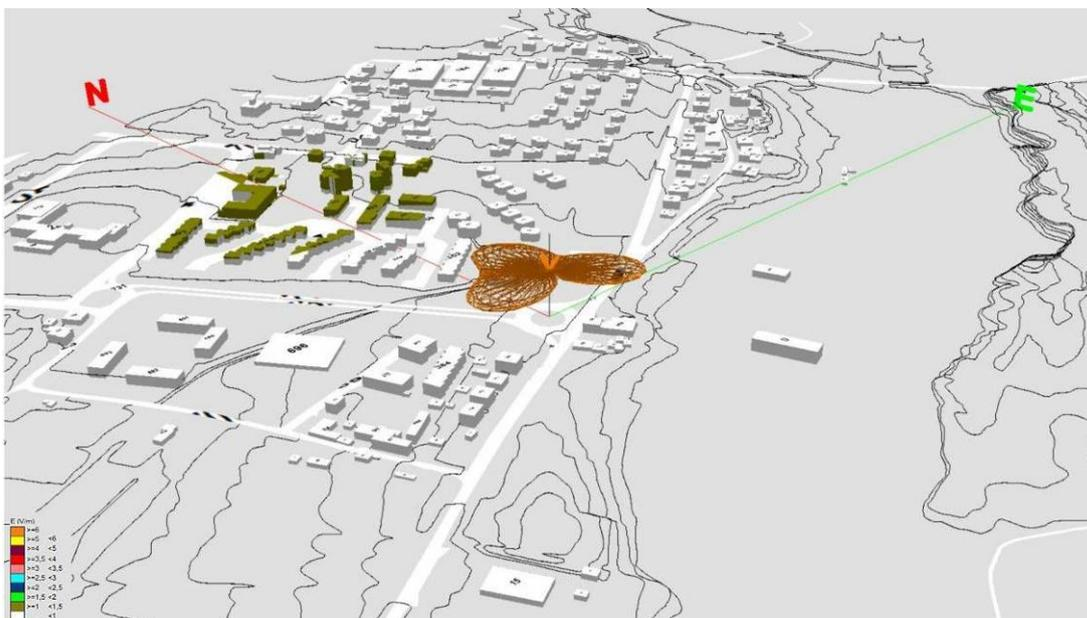
Figura 8.1: esempio di impatto elettromagnetico in uno scenario tridimensionale. Si nota l'area illuminata dal campo elettromagnetico in direzione nord
